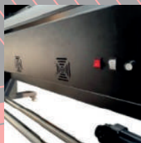
TIRA DE VENTILADORES Y RESISTENCIAS
